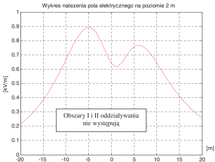
WYKRES NATĘŻENIA POŁA ELEKTRYCZ. LINII 110kV. SŁUP PRZELOTOWY P. Przewody AFL-6 240mm 2 na wysokości 11,0 m nad poziomem terenu. Rys. B-2
