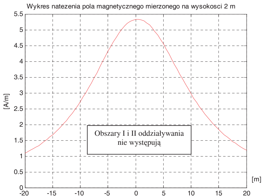
WYKRES NATĘŻ. POŁA MAGNETYCZNEGO LINII 110kV. SŁUP PRZELOTOWY P. Przewody AFL-6 240 mm 2 na wysokości 11,0 m nad poziomem terenu. Rys. B-4
